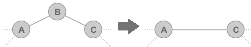
Rysunek 72.6: Operacja usunięcia wierzchołka z grafu
