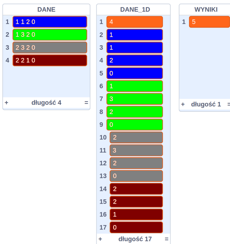
Rysunek 45.4: Reprezentacja mapy w postaci tablicy jednowymiarowej (osobnymi kolorami zaznaczono osobne wiersze mapy)
