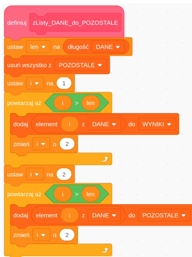
Rysunek 63.3: Crossout Cipher – rozwiązanie bez usuwania elementów
